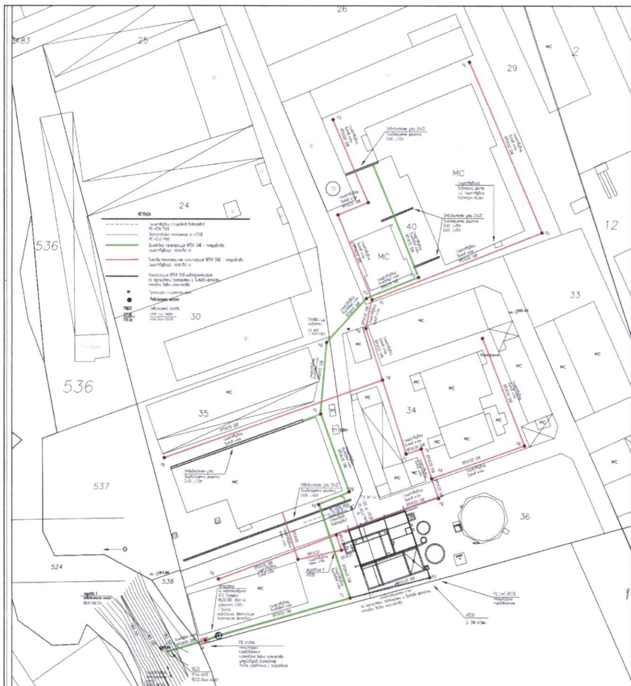
Фигура 1 Схема на канализационната мрежа на площадката
