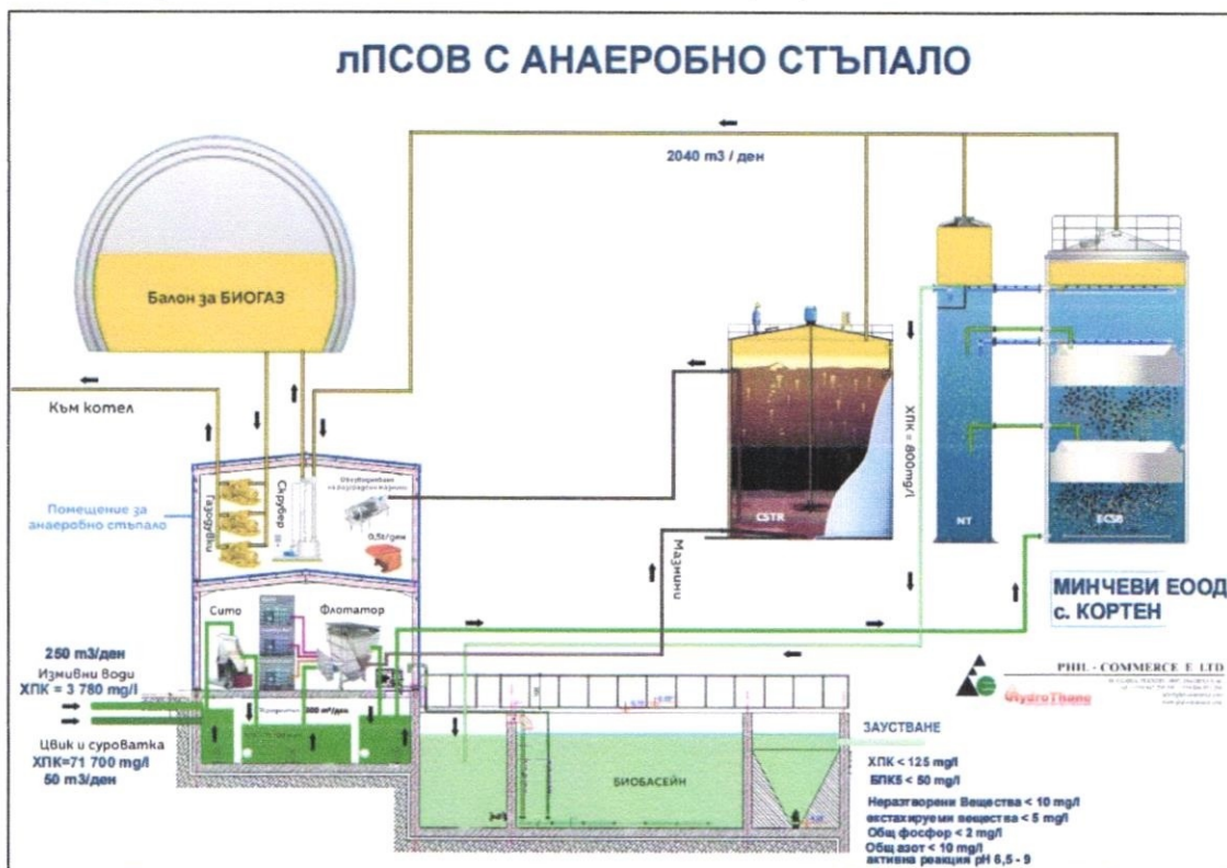
Фигура 4 Принципна схема на оборудването и потоците в ЛПСОВ
